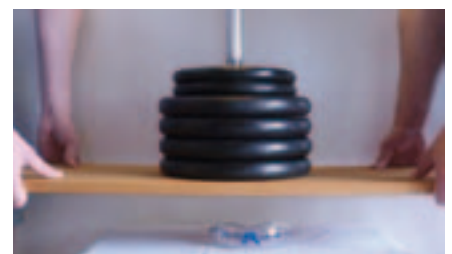
Die Belastungsprüfung simuliert das „Treten“ auf die Brille.
