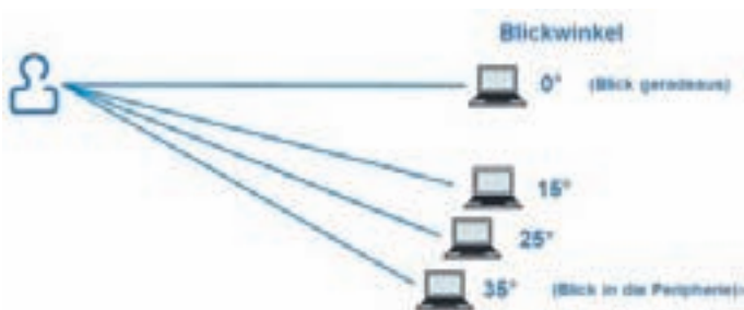
Abb. 6: Versuchsaufbau – die Distanz zwischen Proband und Sehzeichen betrug bei allen Blickwinkeln drei Meter.
