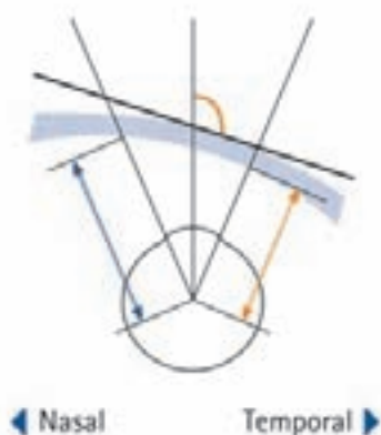
Abb. 4: Senkrecht einfallender Lichtstrahl (a) und – aufgrund höherer Durchbiegung – schräg einfallender Lichtstrahl (b). [7] (Grafik: Seiko)
